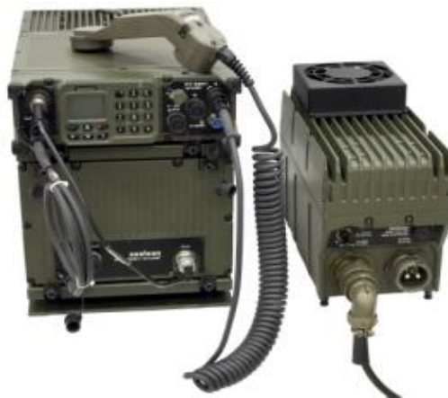
Рисунок 1.9 – Зовнішній вигляд стаціонарного варіанту радіостанції VRC 9661 (50 Вт).
