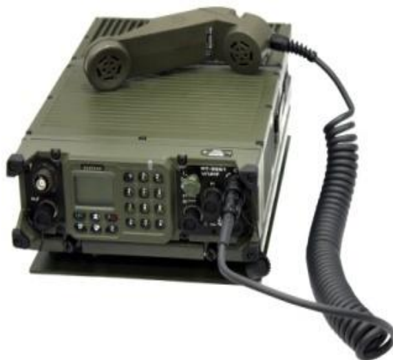
Рисунок 1.7 - Зовнішній вигляд автомобільного варіанту радіостанції VRC 9661 варіант (10 Вт).
