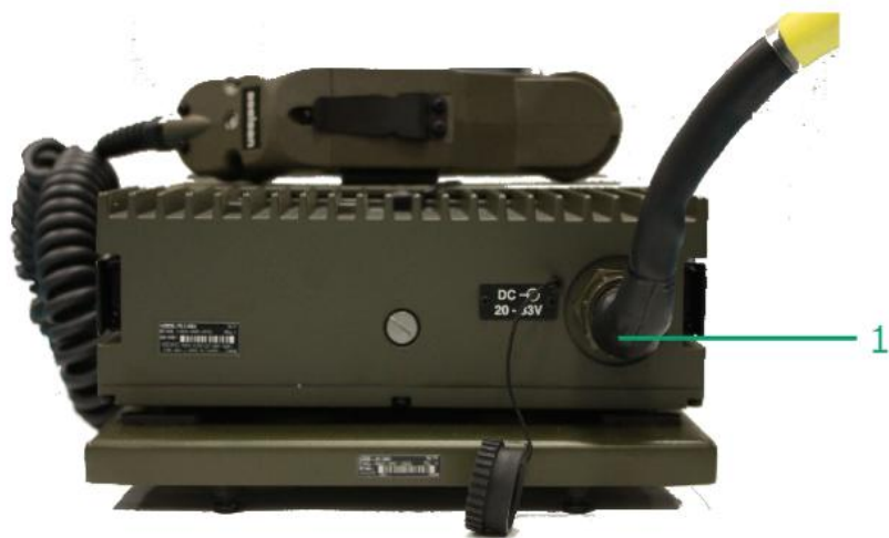
Рисунок 1.13 - Зовнішній вигляд задньої панелі блоку живлення радіостанції VRC 9661.
