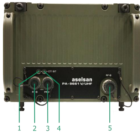
Рисунок 1.14 - Зовнішній вигляд передньої панелі підсилювача потужності 50 Вт радіостанції VRC 9661.
