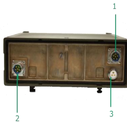
Рисунок 1.11 - Зовнішній вигляд задньої панелі радіостанції VRC 9661.
