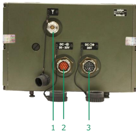
Рисунок 1.15 - Зовнішній вигляд задньої панелі підсилювача потужності на 50 Вт.
