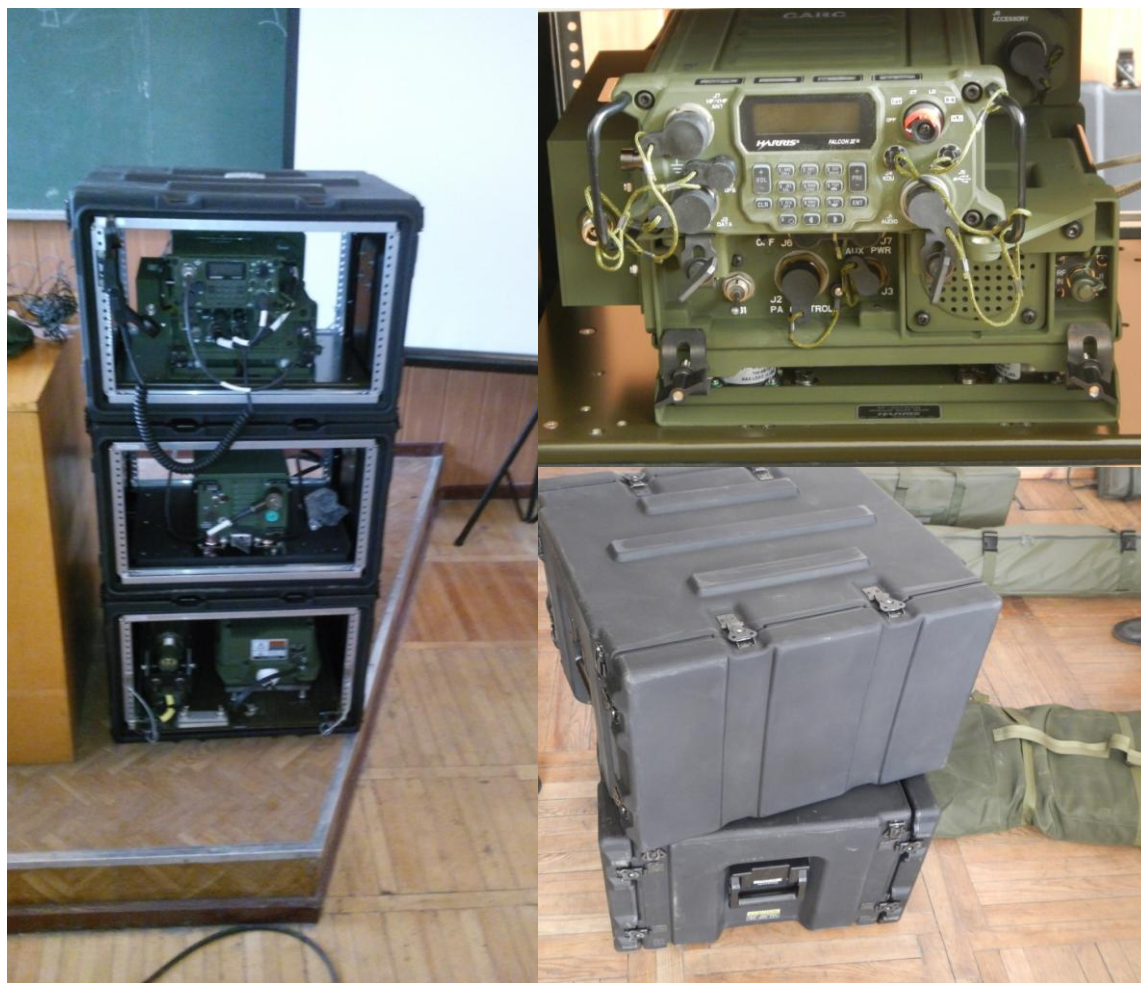
Мал. 8.10. Зовнішній вигляд КХ станції з підсилювачем 150 Вт
