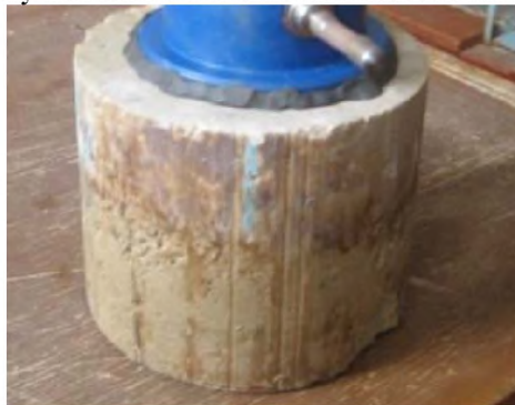
Рис. 1. Зразок ґрунтоцементного елемента
