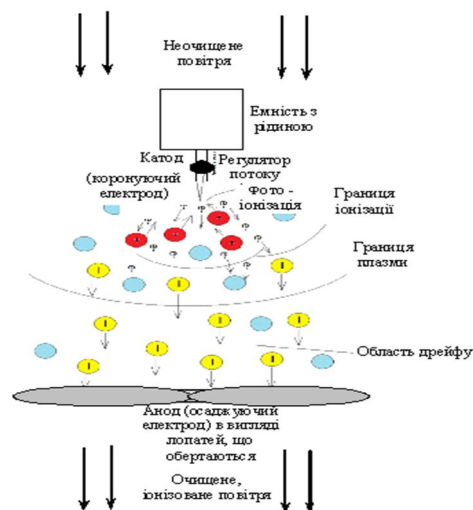
Рисунок. 1. Розпилення рідини в полі негативного коронного розряду.
