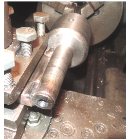
Рисунок 1 – Спосіб виготовлення профільних отворів шляхом ротаційного накочування: а – вигляд ротаційної голівки; б – спосіб закріплення у різцетримачі
