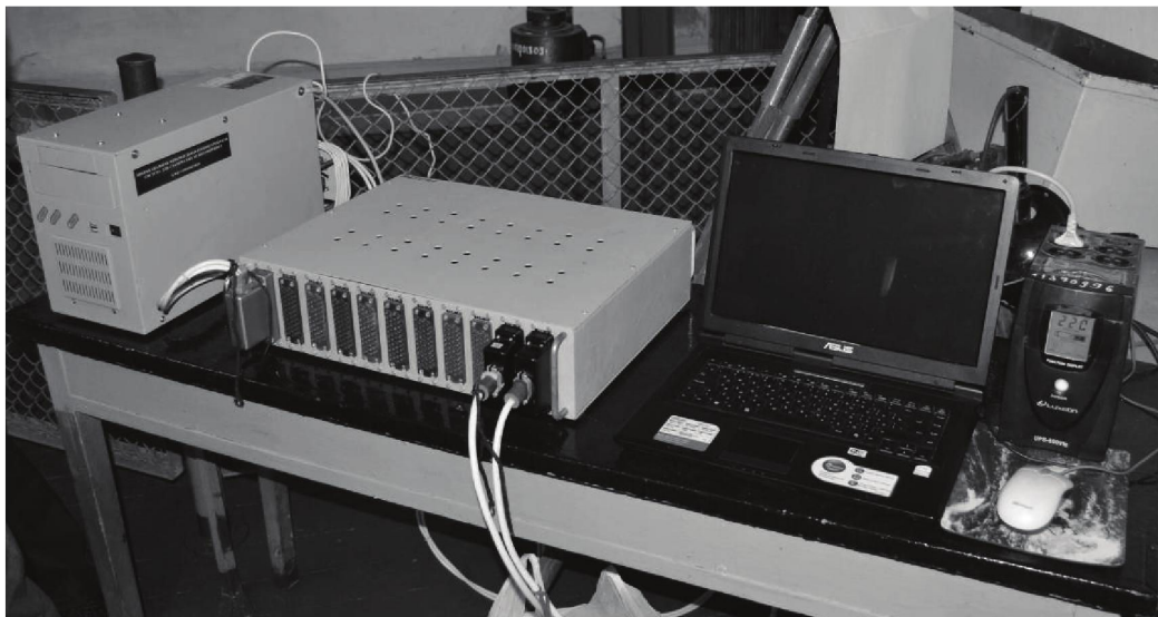
Рисунок 2 – Багатоканальна вимірювальна тензометрична система для статичних випробувань ВВП-8
