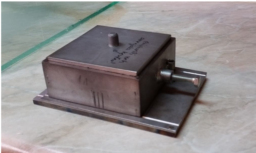
Рис. 3.7 – Адаптація обойми зрізу для випробування тертя сипких матеріалів по сталі
