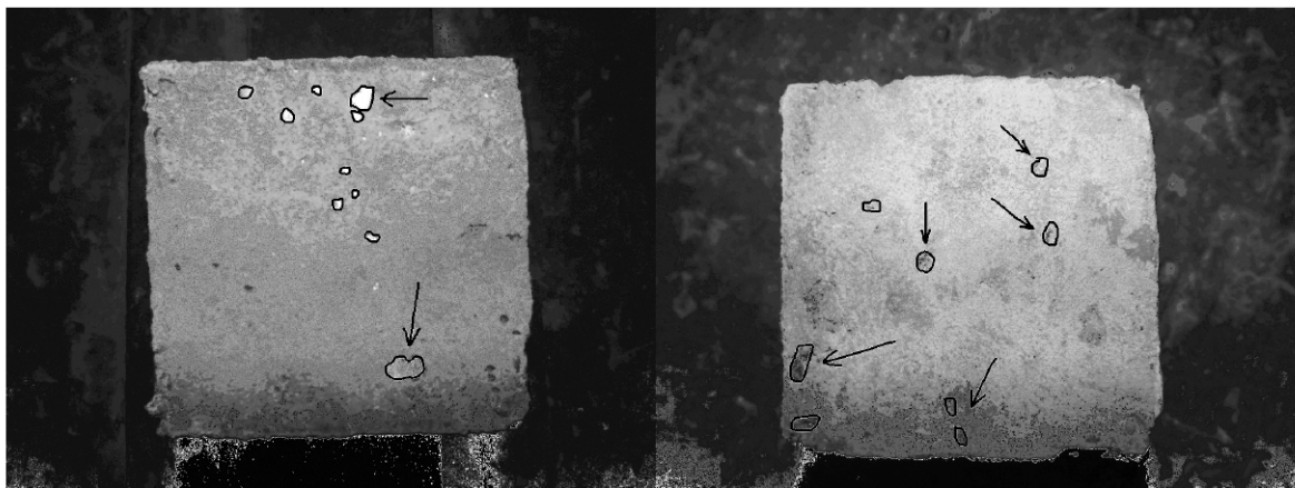
Рисунок 3 – Поверхня сталі (зліва) та бетону після руйнування
