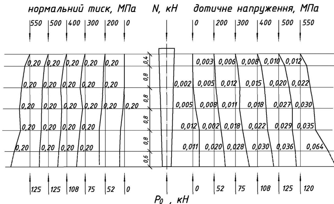
Рис. 7.3 – Епюри нормальних і дотичних напружень за контактом «пірамідальна палля – ґрунт» за даними професора А.Л. Готмана
