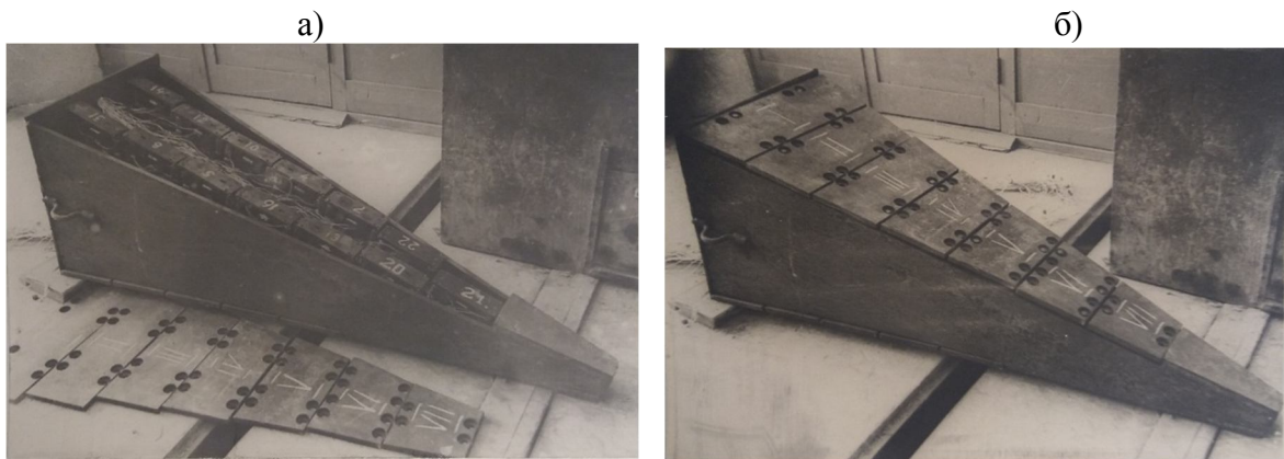
Рис. 7.7 – Етапи збирання інвентарної тензометричної палі: а – встановлення тензодинамометрів; б – загальний вигляд у зборі
