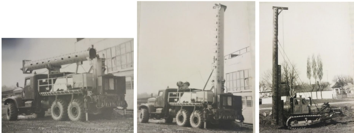
Рисунок 8.7 – Загальний вигляд мобільних установок на базі шасі автомобіля КРАЗ і гусеничного трактору Т-130
