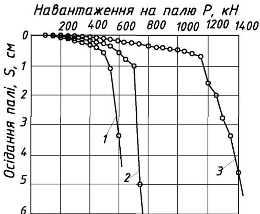
Рис. 7.1 – Графіки випробувань пірамідальних паль: 1 – паля №1; 2 – паля №2; паля №3
