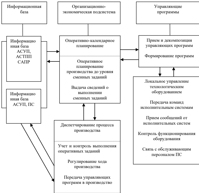
Рис. 4.8. Основные элементы и функции производственной системы
