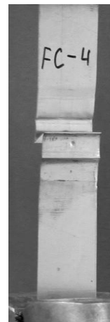
Рис. 8. Фальцеве подвійне з'єднання
