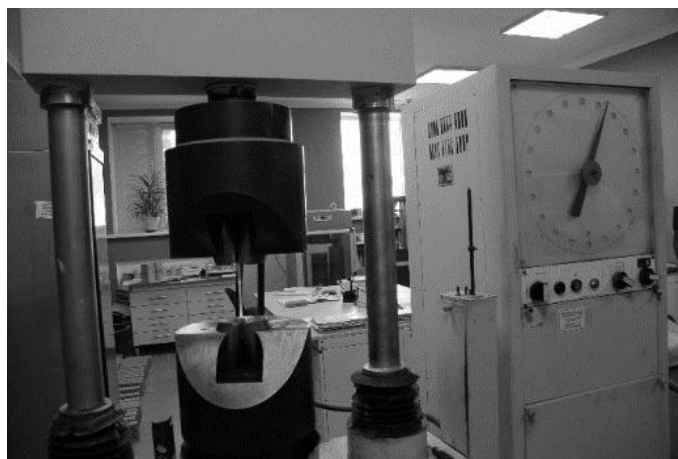
Рис. 4. Машина випробувальна на розтяг МР-500
