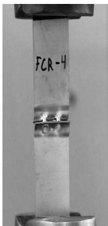
Рис. 10. Фальцеве + заклепкове подвійне з'єднання
