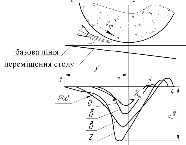
Рис. 4 – Розподіл тиску в гідравлічному клині по довжині поверхні шліфування: а – круг 24А40НС17К6 (охолодження ЕТ-2); б – круг 24А6НС17К6 (охолодження ЕТ-2); в – круг 24А6НС17К6 (охолодження И-20А); г – круг 24А6НС1В (охолодження ЕТ-2)
