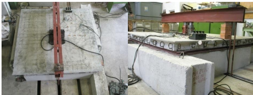
Фото 1 – Експериментальна установка з надколонною плитою під час випробування
