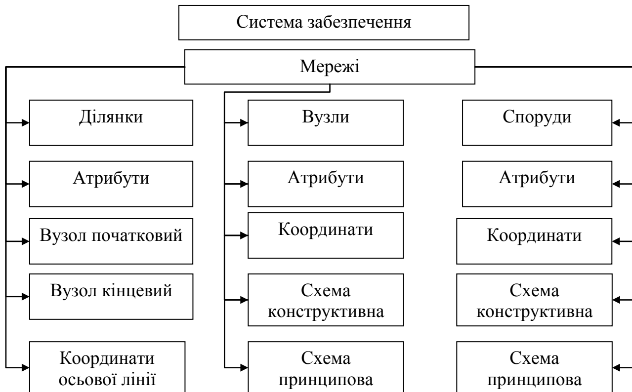
Рис. 3.2. Структура об'єктів мереж інженерних комунікацій
