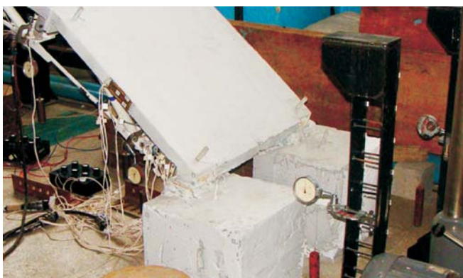
Рис. 5. Загальний вигляд розміщення обладнання для вимірювання переміщень
