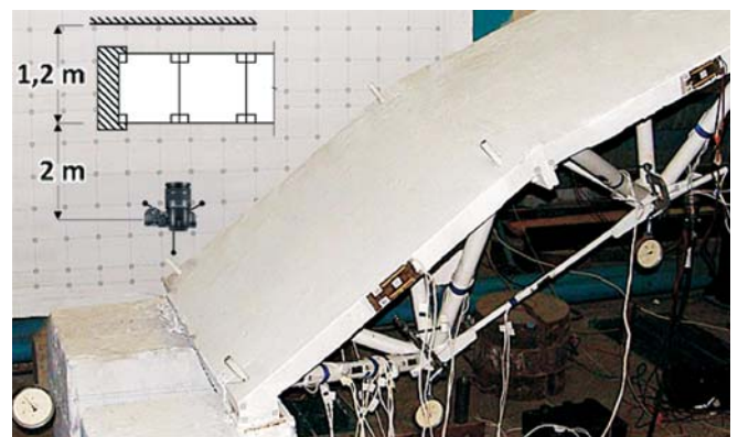
Рис. 6. Загальний вигляд розміщення обладнання для вимірювання переміщень методом фотограмметрії
