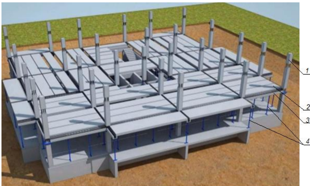
Рисунок 1.17 – Загальний вигляд каркасу конструктивної системи «УДС» на стадії монтажу:
