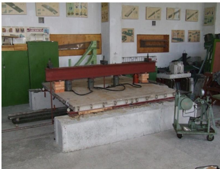
Рис. 2.12 – Загальний вигляд стенду для випробування надколонних плит
