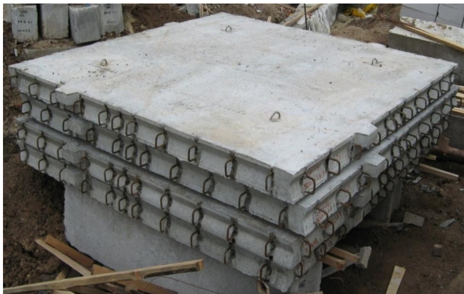
Рисунок 4.11 – Загальний вигляд середніх одномодульних виготовлених на заводі плит (ПС 30.30.1,6-2-3)
