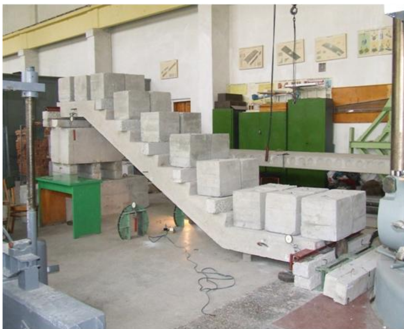
Рис. 2.18 – Загальний вигляд стенду для випробування сходового маршу
