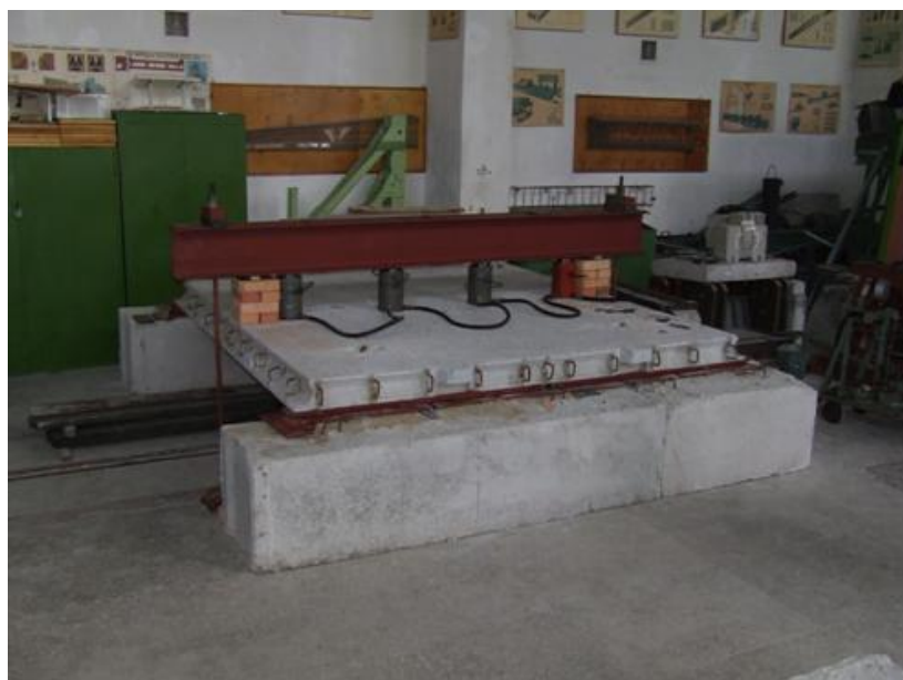
Рис. 2.14 – Загальний вигляд стану для випробування міжколонних плит
