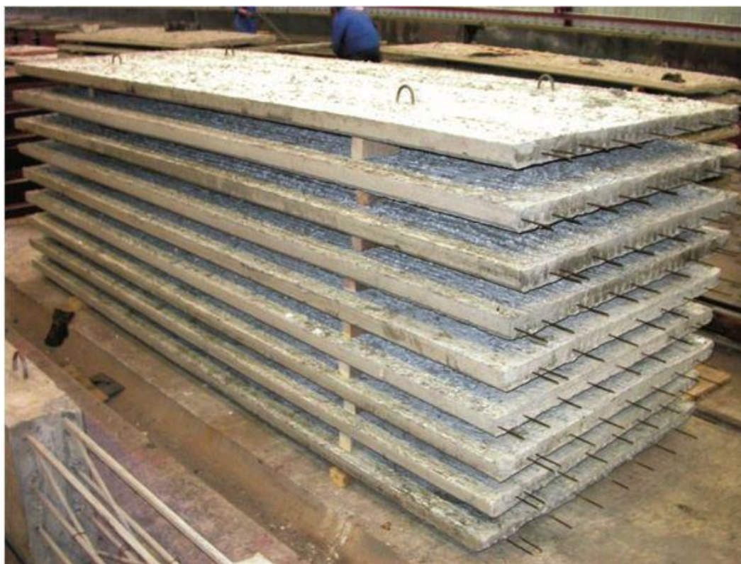
Рисунок 1.19 – Загальний вигляд плити-опалубки
