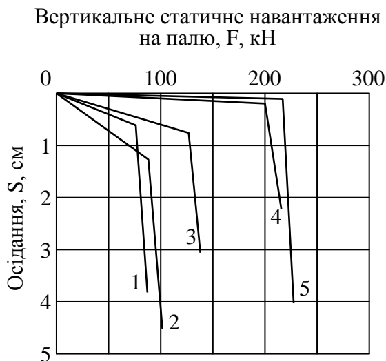
Рис. 15.4. Залежність “осідання-навантаження” при кількості енергії на 1 м.п. палі: 1 – без закріплення; 2 – 9 кв/год; 3 – 18,6 кв/год; 4 – 28,4 кв/год; 5 – 32,4 кв/год
