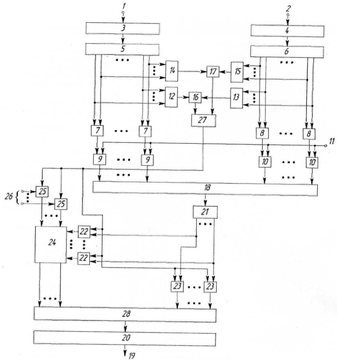
Винахід належить до області обчислювальної техніки та автоматики і призначена для множення лишків  $a_i$  та  $b_i$  числа за довільним модулем  $m_i$  системи залишкових класів (СЗК).
