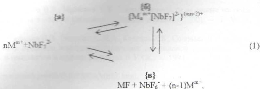
где  $n$  – координаційне число по катиону,  $m$  – заряд катиона, а в качестве катионов наиболее эффективного действия были выбраны:  $M=Li^+$ ,  $Ca^{2+}$  и  $Mg^{2+}$ .
