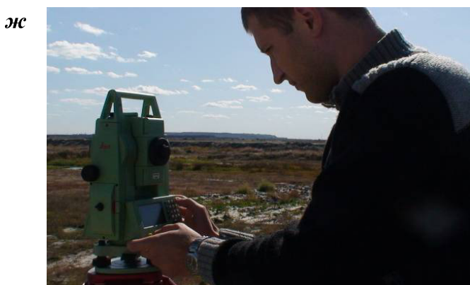
Рис. 2.5 – Методика польових досліджень неоднорідності ущільнених: a, б, в, г, д – відбір зразків ущільнених порід у шурфі, пройдену в штучній основі; е, ж – визначення товщини шару оптичним нівеліром й електронним тахеометром відповідно; 12 – кількість відібраних з горизонту зразків ґрунту
