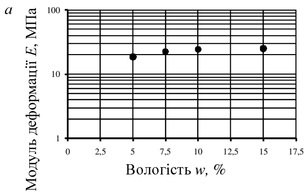
Рис. А.12 – Залежності модуля деформації E піску середньої крупності, однорідного від вологості ґрунту w для інтервалів тиску при компресійних випробуваннях \sigma=0,2-0,3 МПа для питомого об'єму скелету ґрунту: a - 1/\rho_d = 0,55 ; б - 1/\rho_d = 0,60
