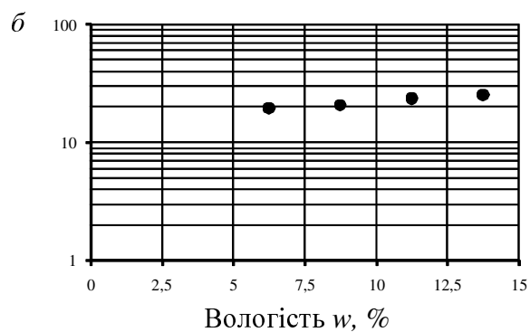
Рис. А.23 – Залежності питомого зчеплення c піску мілкого з домішками супіску від вологості ґрунту w для питомого об'єму скелета ґрунту:
