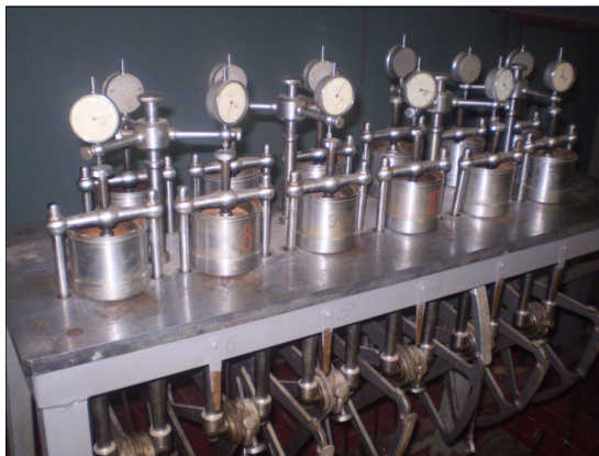
Рис. 2.6 – Лабораторне обладнання для визначення механічних характеристик ґрунту ( E , \varphi , c ): а – компресійні прилади; б – прилади одноплощинного зрушення
