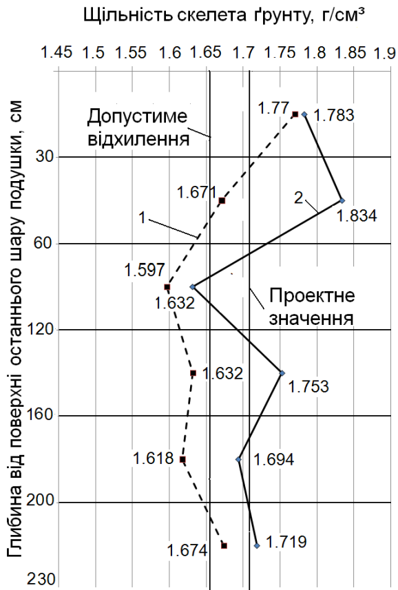
Рис. 3.3 – Графіки зміни щільності скелета ґрунту за глибиною ущільненої подушки (при товщині шарів 30 – 60 см) самохідним котком у вібраційному та статичному режимах роботи за 8 проходів одним слідом: 1 – у статичному режимі роботи; 2 – у вібраційному режимі роботи
