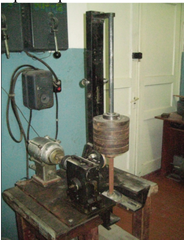
Рис. 2.1 – Прилад динамічного ущільнення ґрунтів МДУ-1
