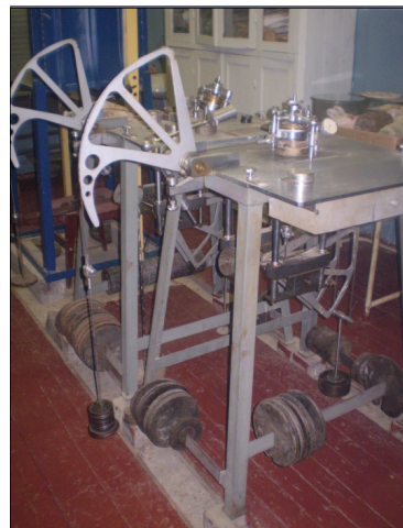
Рис. 2.6 – Лабораторне обладнання для визначення механічних характеристик ґрунту ( E , \varphi , c ): а – компресійні прилади; б – прилади одноплощинного зрушення
