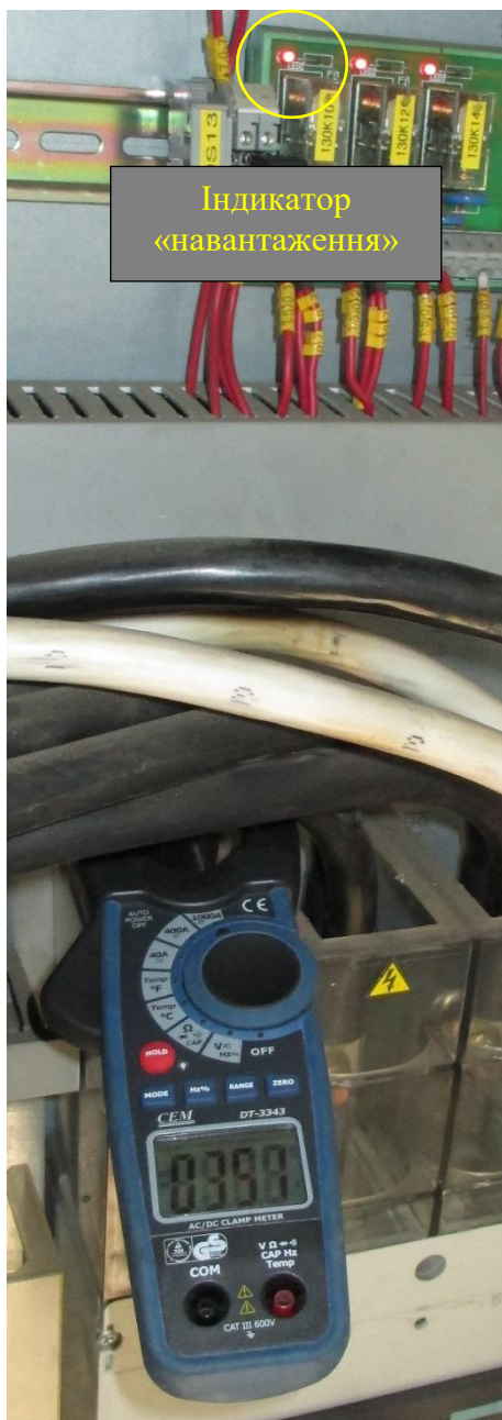
Рис. 3. а) Струм 351 А в режимі «навантаження»; б) Струм 156 А в режимі «розвантаження»
