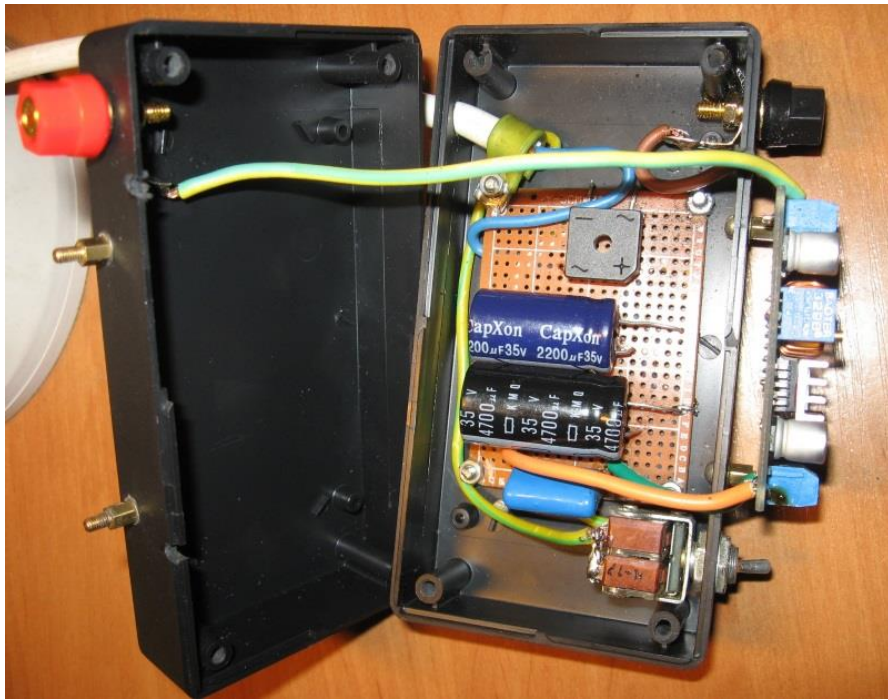
Рис. 7. Конструктивне виконання блока перетворювача
