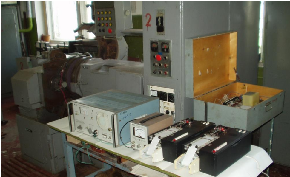
Рис. 1 – Експериментальний стенд на базі двох стороннього торцево-шліфувального верстата моделі 3342 АДО
