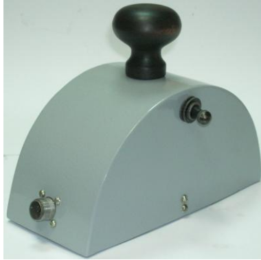
Рис. 2 – Загальний вигляд розробленого накладного електромагнета
