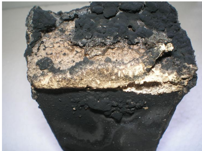
Рис. 3 – Спучений шар пінококсу на поверхні деревини після вогневих випробувань
