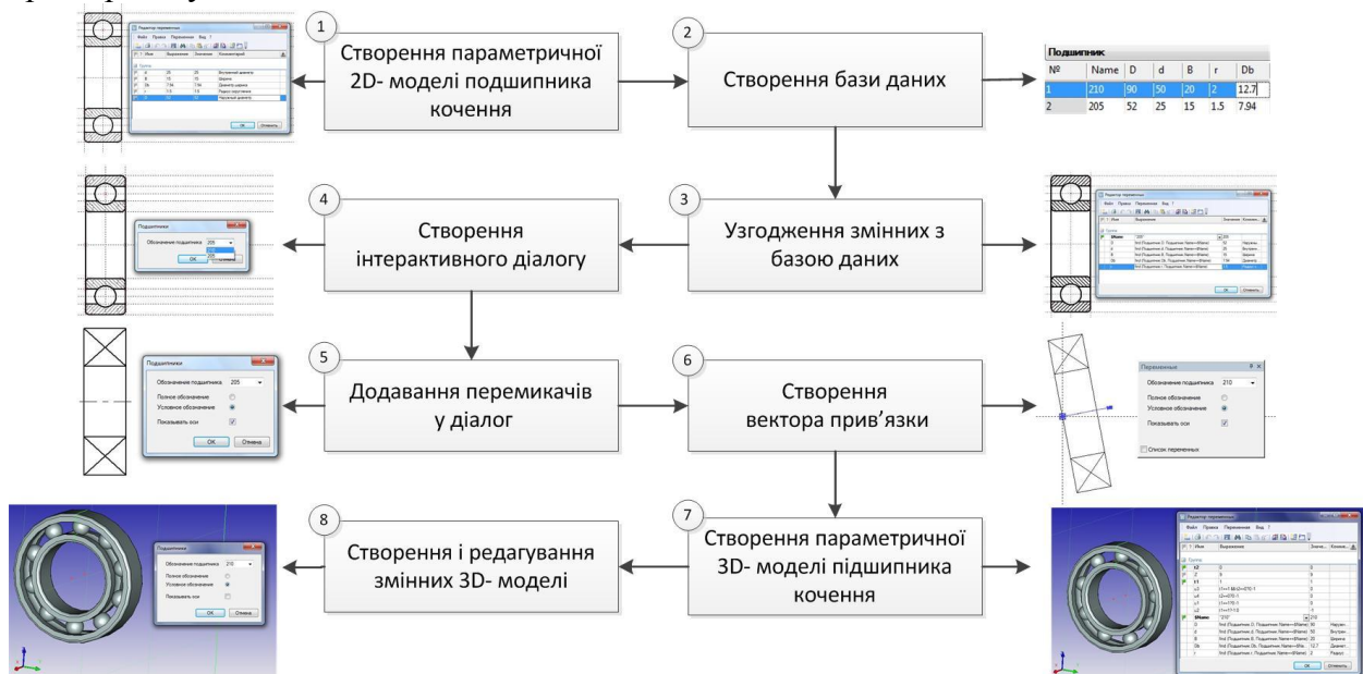
Рис. 1 – Послідовність створення внутрішньої бібліотеки підшипників кочення в системі «T-FLEX-CAD».
