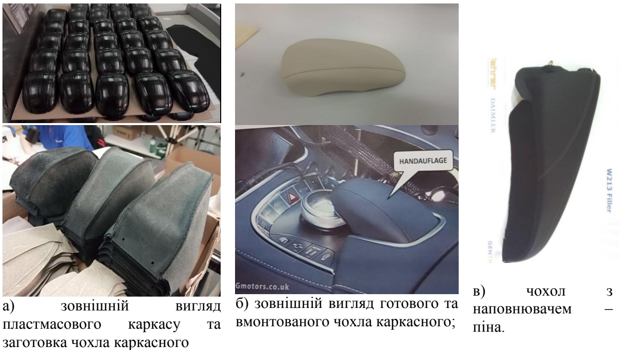
Рис. 2 – Каркасні аксесуари, виготовлені зшивним способом
