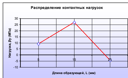
Рисунок 7 – Эпюра линейно распределенной нагрузки вдоль режущего лезвия развертки при применении в качестве СОТС животного (свиного) жира
