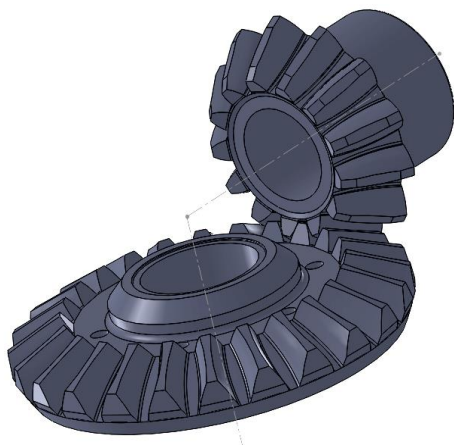
Рисунок 1 – Исследуемая коническая передача с ДВВ–зубьями
