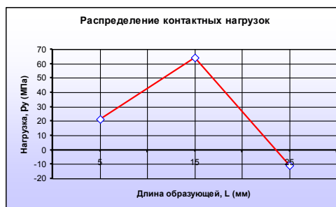
Рисунок 5 – Эпюра линейно распределенной нагрузки вдоль режущего лезвия развертки при применении в качестве СОТС минерального масла И-20
