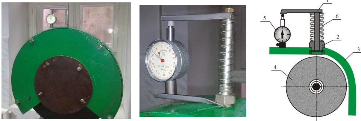
Рисунок 3 – Схема устройства для измерения радиального износа отрезных кругов
