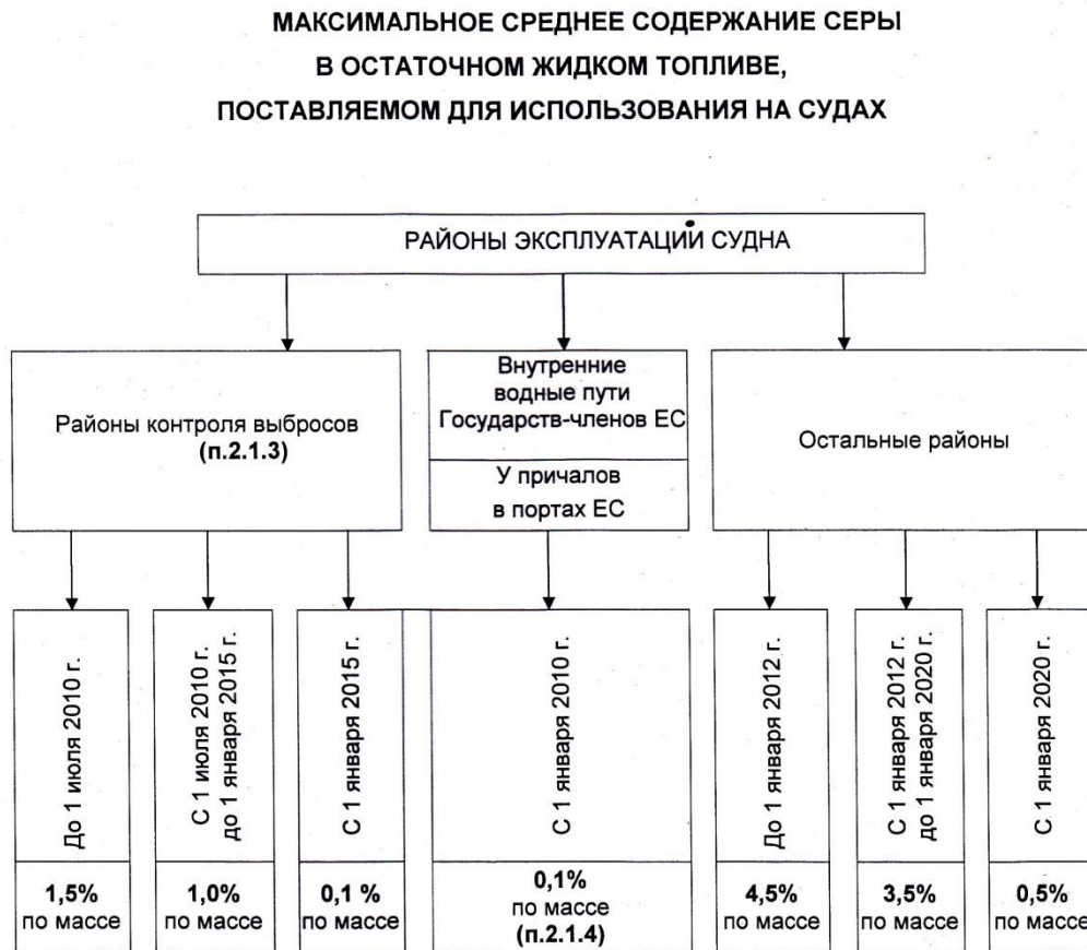
Рисунок 1 – Новые перспективные требования по содержанию серы в жидком топливе в зависимости от района плавания
