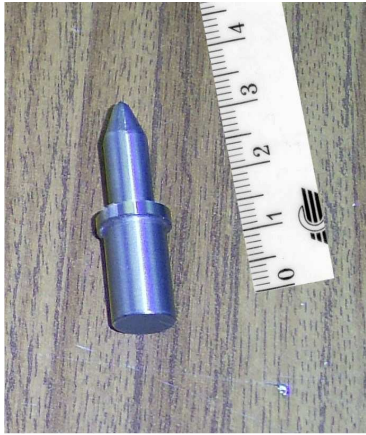
Рисунок 1 – Конструкція термопластичного свердла
