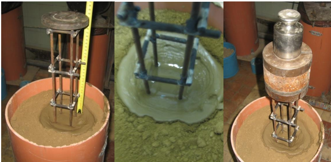
Рис. 3.11 – Лабораторні дослідження процесу заглиблення моделі арматурного каркасу в ґрунтоцемент
