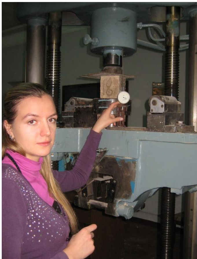
Рис. 2.18 – Випробовування дослідних зразків на осьове стиснення
