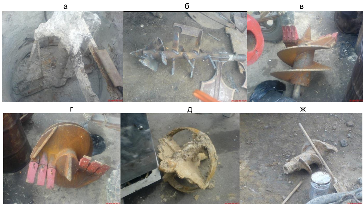
Рис. 1.6 – Бурозмішувачі для влаштування ґрунтоцементних паль: а – напірний; б – лопатевий; в, г – шнековий; д – крильчасті; ж – гвинтовий
