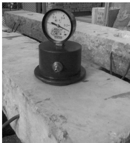
Рис. 2.27 – Визначення повітропроникності бетонної балки
