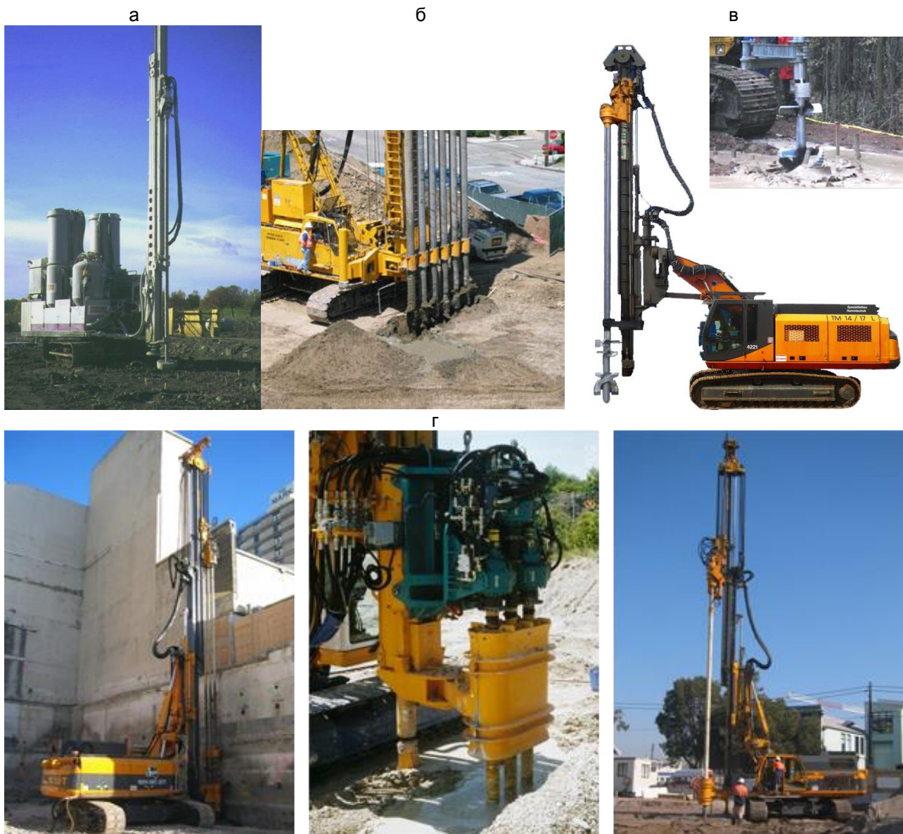
Рис. 1.2 – Сучасні машини для виготовлення ґрунтоцементних паль за бурозмішувальним методом: а – шведської компанії Alimak AB; б – японської компанії Seiko Kogyo Co з виготовлення ґрунтоцементу методом сухого перемішування; в – компанії ABI установка ABI TM 14-17 для виготовлення ґрунтоцементних паль (діаметр наконечника-змішувача 800 мм); г – бурозмішувальна установка Bauer BG28 з навісним обладнанням Evrodrill SMW 550 для виготовлення ґрунтоцементних стін (кількість змішувачів 3 (1400x550 мм))
