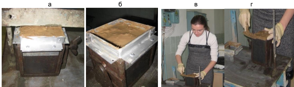
Рис. 2.14 – Формування кубика з додатковою насадкою: а – початок формування; б – кінець формування; в, г – зрізання надлишку ґрунтоцементу
