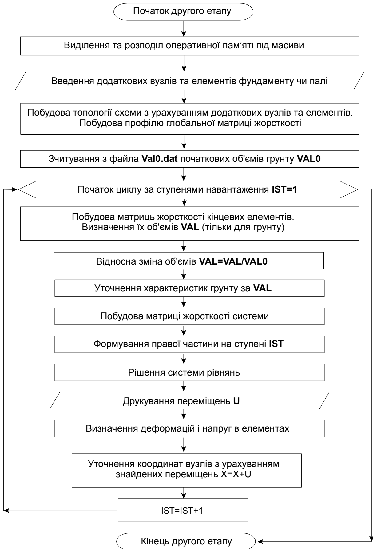
Рисунок 2.16 – Блок-схема другого етапу комплексу “PRIZ-Pile”
