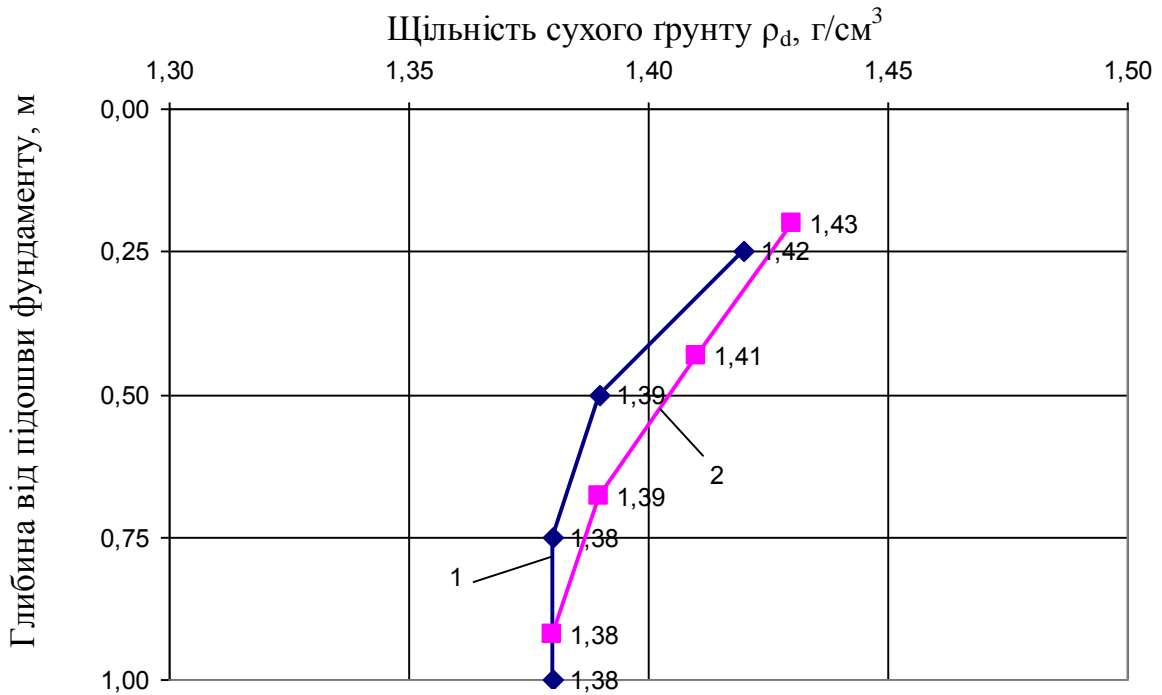
Рисунок 3.39 – Зміна щільності сухого ґрунту за глибиною тривало обтисненої основи під підшвою фундаменту за: 1 – експериментом; 2 – моделюванням
