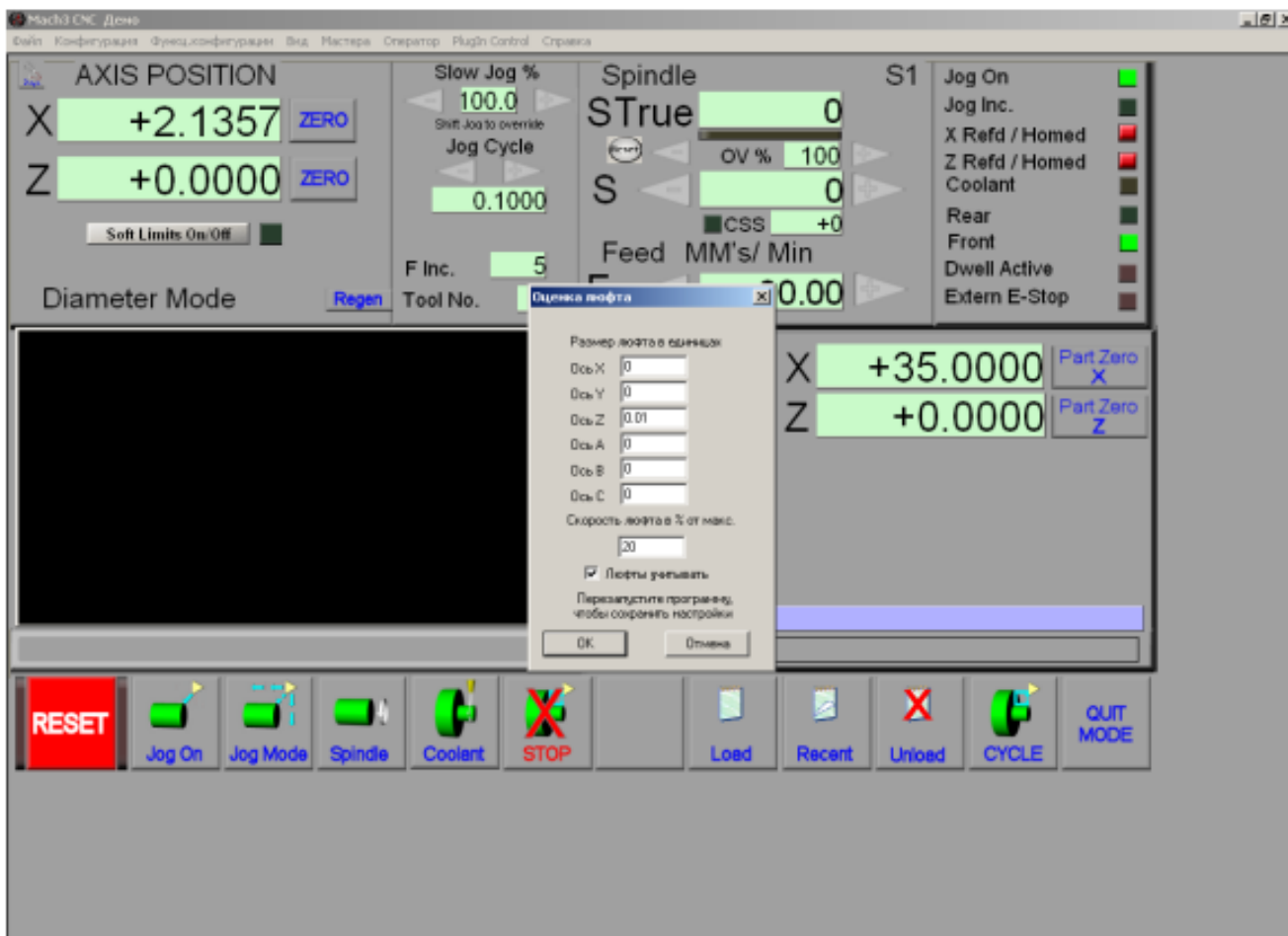
Рисунок 3.3 – Меню включення компенсації люфтів у програмі Mach3 Вісь Z.
