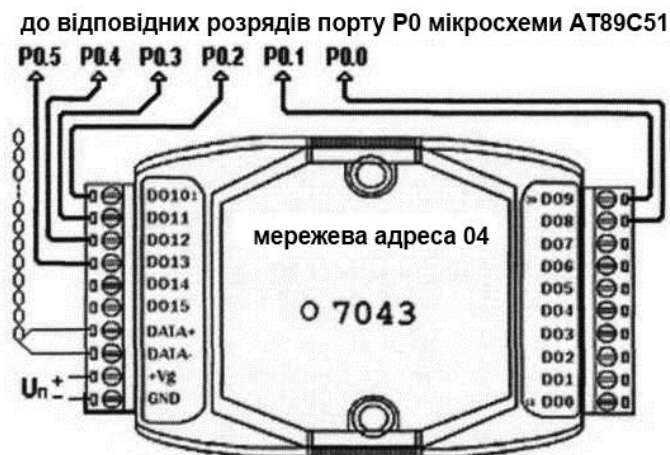
Рисунок 4.9 -Схема комутації виходів модуля I7043, які використовуються для керування асинхронними двигунами
