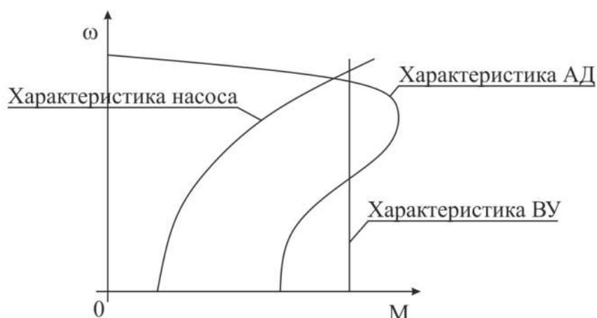
Рисунок 1.2 - Механічні характеристики АД, насоса та ВУ
