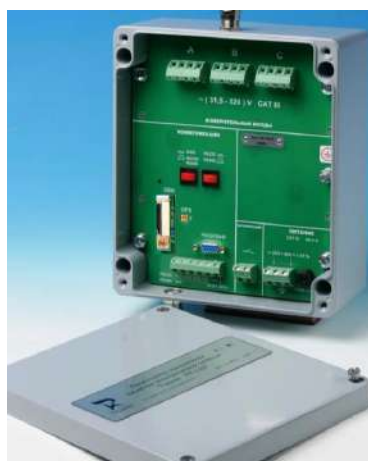
Рисунок 2.7 – Зовнішній вигляд реєстратора ПЯЕ «Парма РК3.02» [3]
