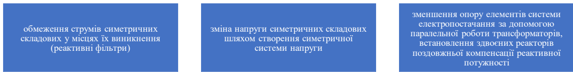
Рисунок 3.20 – Технічні заходи підвищення якості електроенергії
