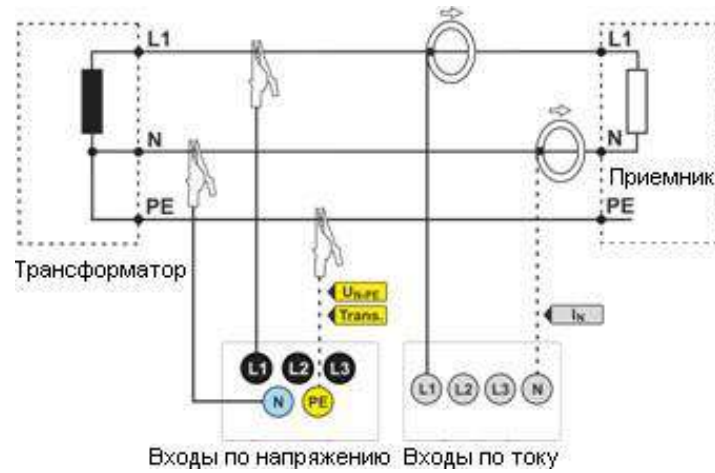
Рисунок 2.12 – Схема підключення – однофазна мережа
