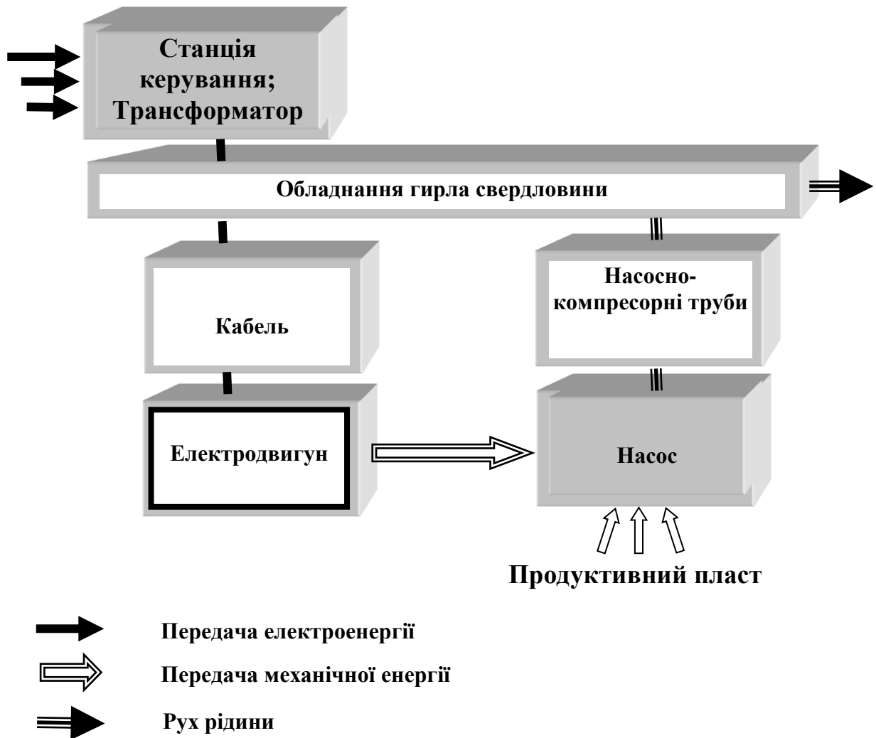
Рисунок 1.3 – Структура привода штангової свердловинної насосної установки
