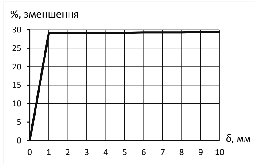
Рис. 38 - Відсоток зменшення приведенного опору теплопередачі огородження в залежності від довжини тріщини
