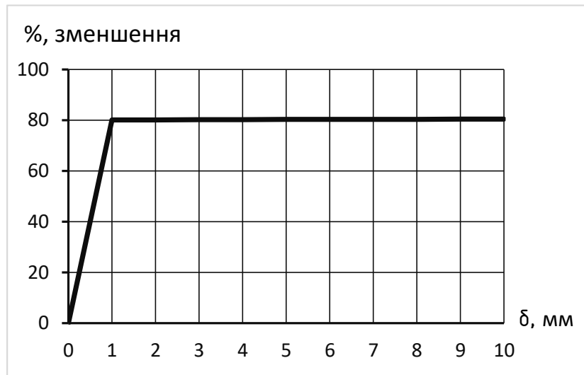
Рис. 80 - Відсоток зменшення приведенного опору теплопередачі огородження в залежності від довжини тріщини
