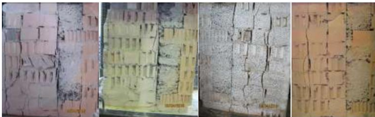
Рис. 13 – Загальний вигляд руйнування центрово-стиснутих зразків
