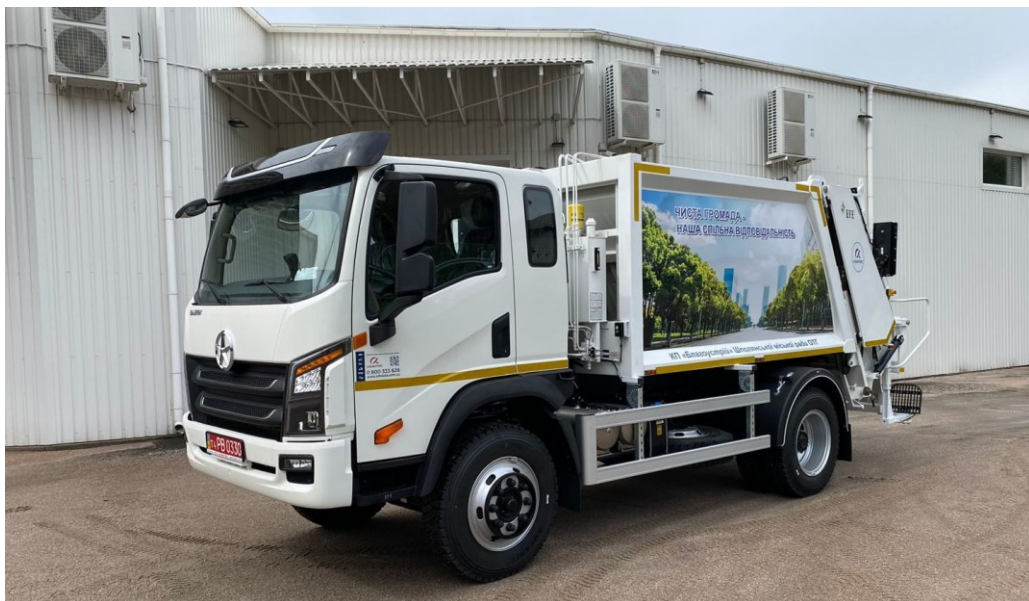
Рис. 4. Автомобіль сміттєвоз із заднім механізованим завантаженням АТ-4021 (передній відвал навішується за необхідності)
