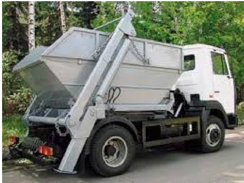
Рис. 6. Смітєвоз-мультиліфт з контейнером об'ємом 8\text{м}^3
