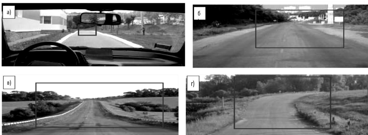
Рис. 1.13. Орієнтовні розміри поля концентрації уваги водія, обкреслені на вітровому склі автомобіля рамкою 16×10 см: а – положення рамки на вітровому склі; б – прямолінійна ділянка дороги; в – підйом; г – крива в плані (Степанов О.В.)
