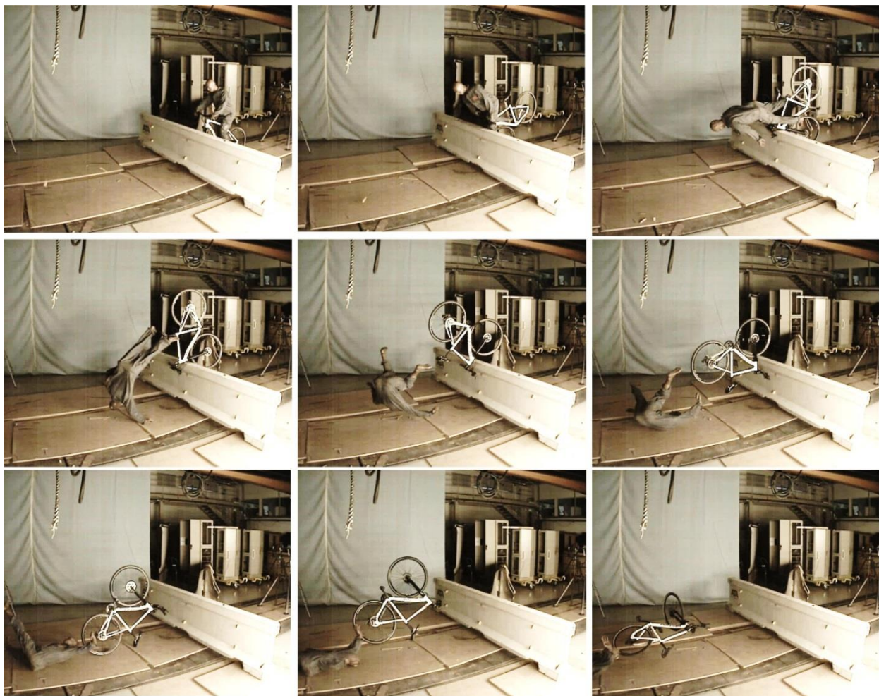
Рис.1.23. Дослідження параметрів дорожнього огородження та їх вплив на велосипедиста при зіткненні.
