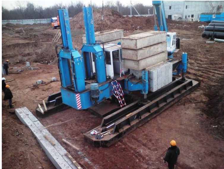
Рисунок 2.2 – Палевдавлююча мобільна установка статичного вдавлення
