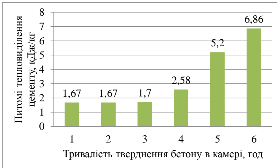
Рис. 5.41. Питомі тепловиділення цементу під час гідратації, кДж/кг ( \rho = 450 \text{ кг/м}^3 , V/\rho = 0,55 )
