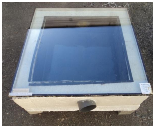
Рис. 5.6. Колектор сонячної енергії № 3 власної конструкції
