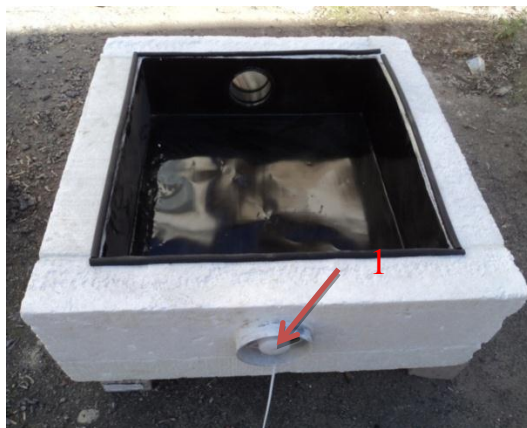
Рис. 5.7. Колектор сонячної енергії № 3 власної конструкції (без склопакета – для відображення конструкції):
