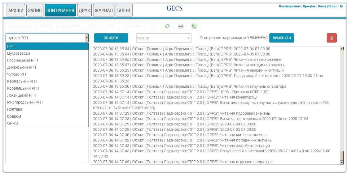
Рис. 2.4. Процес дистанційного отримання інформації з приладів обліку газу у програмному додатку «GECS»
