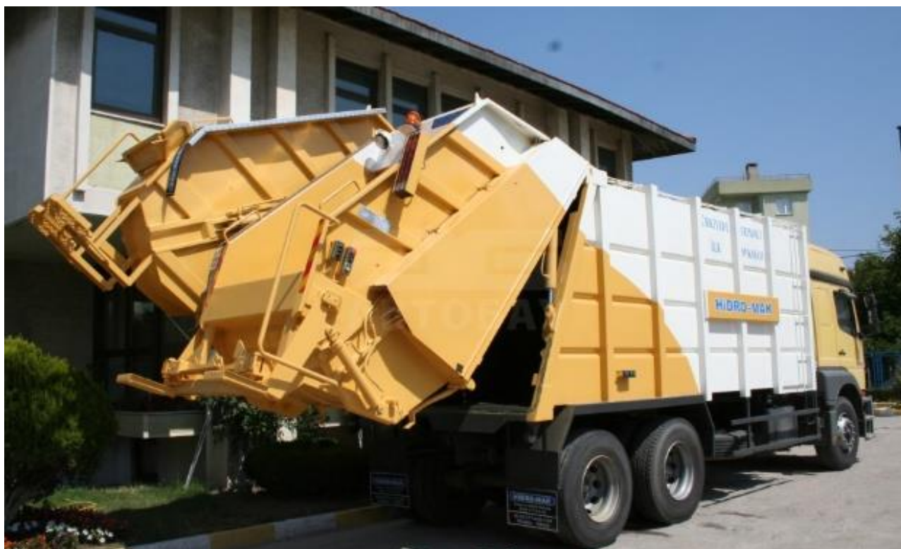
Рис. 7. Кузовний двохсекційний сміттєвоз.
