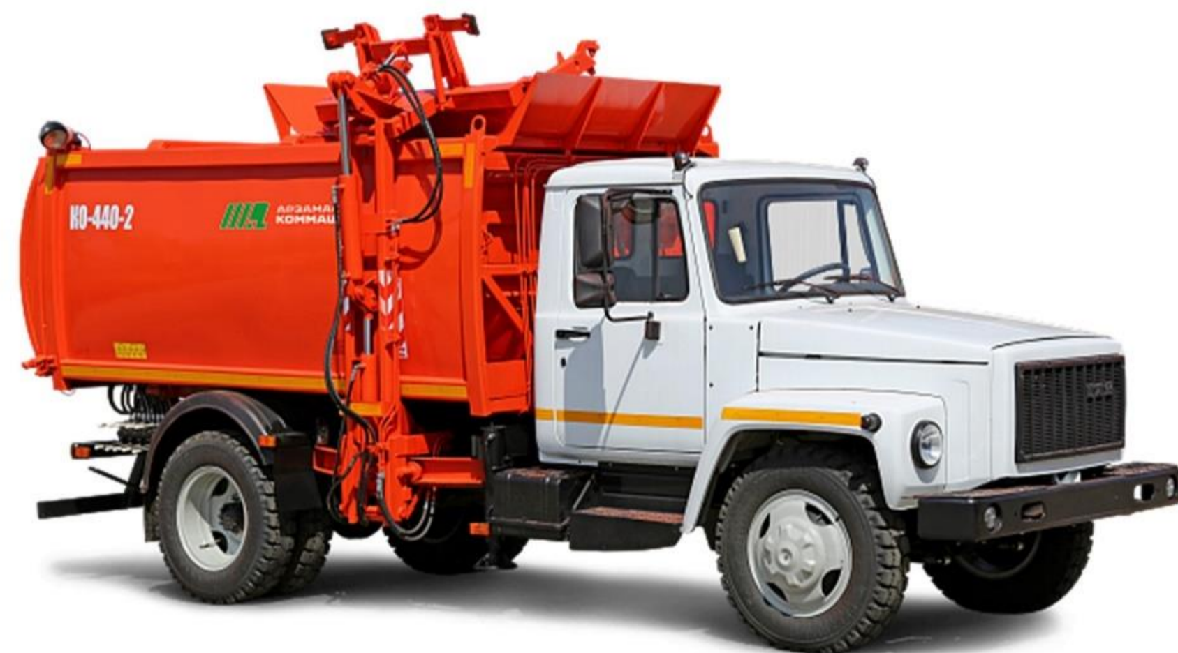
Втомобіль сміттєвоз із заднім механізованим завантаженням АТ-4031
