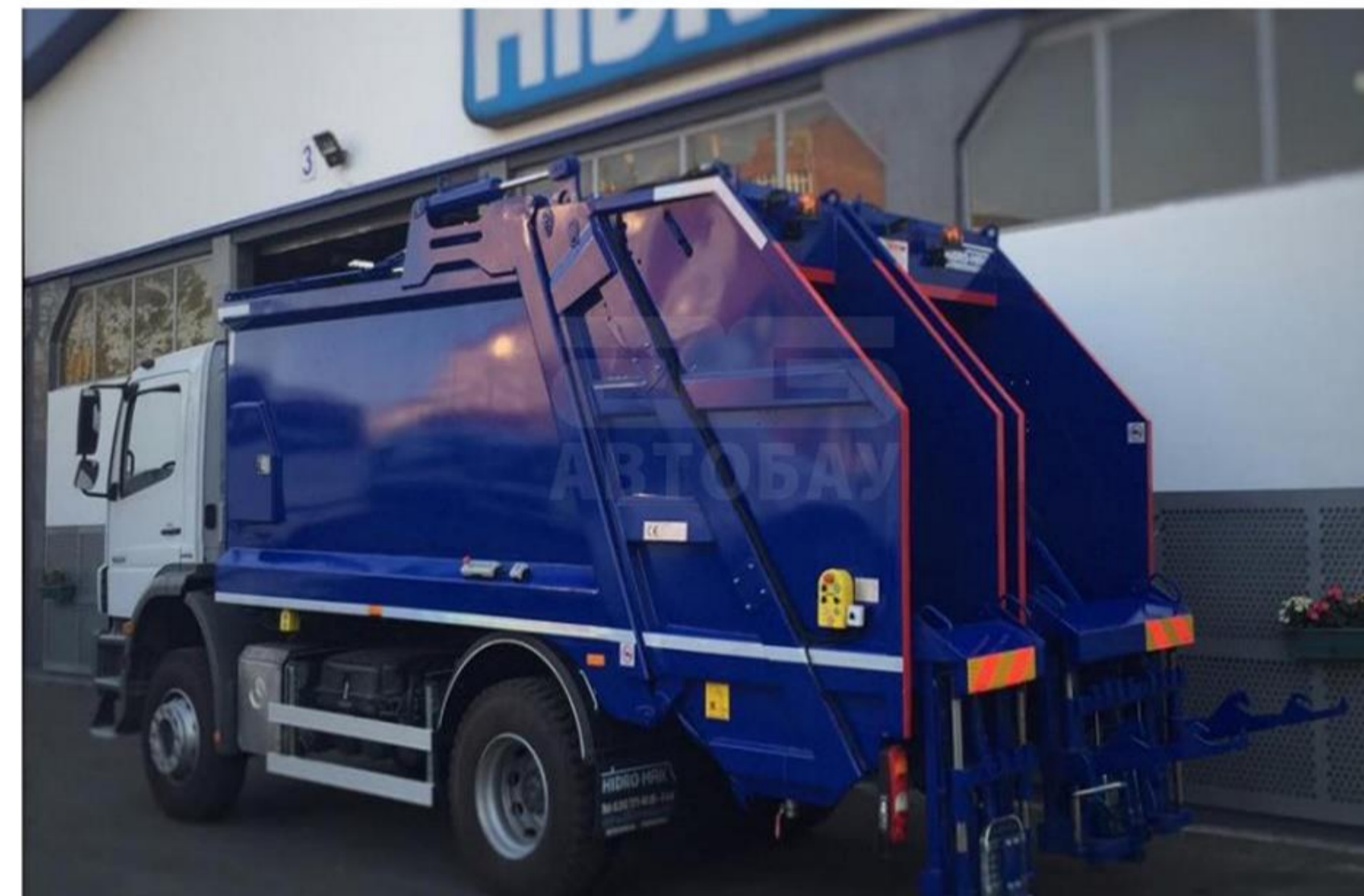
Автомобіль сміттєвоз із заднім механізованим завантаженням Hydro-tak ECOTWIN на шасі FORD-1833
