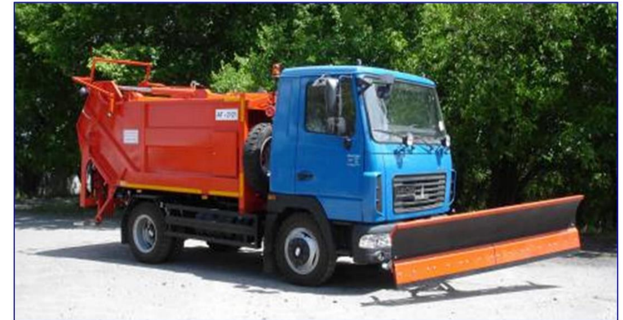
Втомобіль сміттєвоз із заднім механізованим завантаженням АТ-2121
