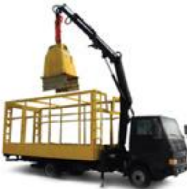
Рис. 11. Смітєвоз-контейнеровоз з краном-маніпулятором
