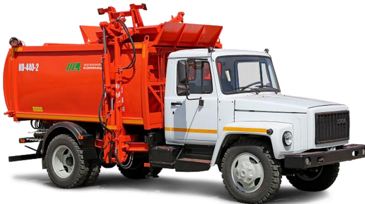
Рис. 9. Автомобіль сміттевоз із бічним механізованим завантаженням серії КО-440.
