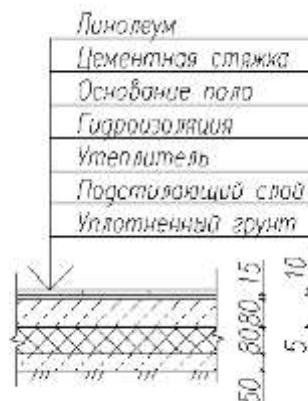
Рисунок 1.9. - Схема влаштування підлоги з лінолеуму
