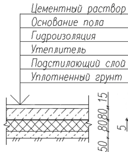
Рисунок 1.10. Схема влаштування бетонної підлоги
