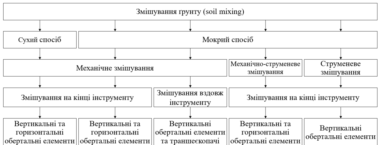
Рис. 1.2. Класифікація змішування ґрунту на основі форми в’язучого, принципу змішування та місця дії змішування за М. Topolnicki
