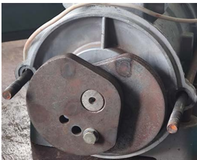
Рис. 3.14. Методи зміни діапазонів та інтервалів варіювання параметрів: а) збурюючої сили P ; б) ваги m_6 ; в) довжини важеля \ell_{важ.} .
