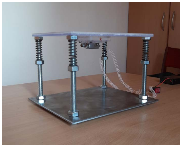
Рис. 3.1. Дослідна модель вібростолу з важільним закріпленням віброзбуджувача: а) – з важілем, б) – без важеля.
