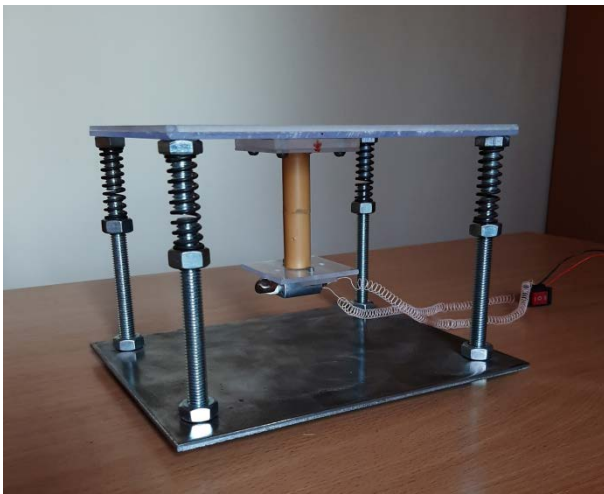
Рис. 3.1. Дослідна модель вібростолу з важільним закріпленням віброзбуджувача: а) – з важілем, б) – без важеля.
