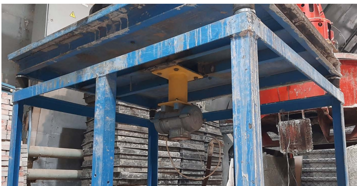
Рисунок 4.1. Малогабаритне обладнання для віброформування бетонних виробів з важільним закріпленням віброзбуджувача.
