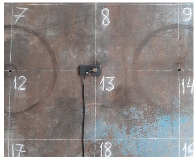
Рис. 3. 16. Розташування точки виміру значення амплітуди вертикальних вимушених коливань.
