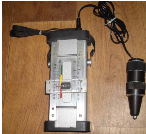
Рис. 3.2. Віброметр ИСП-1 для вимірювання значень ударних імпульсів (дБ).
