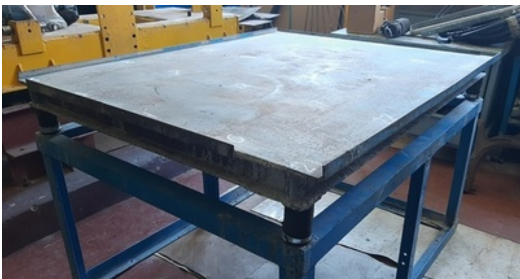
Рис. 3.8. Дослідне малогабаритне обладнання для віброформування бетонних виробів.
