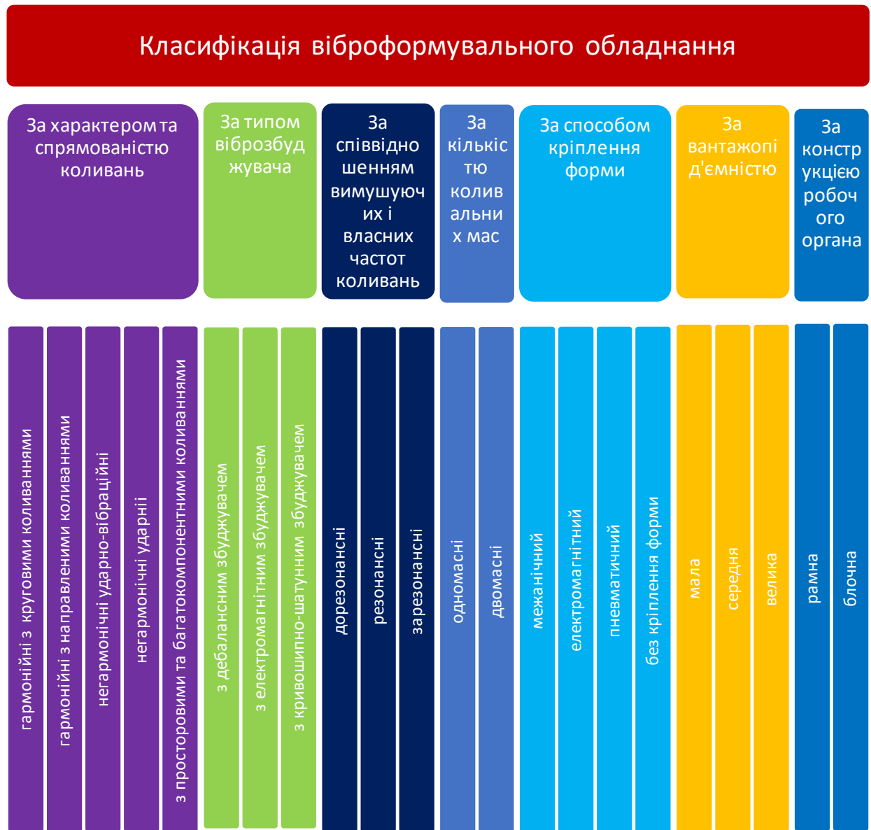
Рис. 1.1. Класифікація віброформуального обладнання
