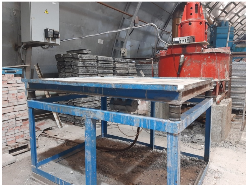
Рис. 3.13. Проведення експерименту на дослідному малогабаритному обладнанні для віброформування бетонних виробів.
