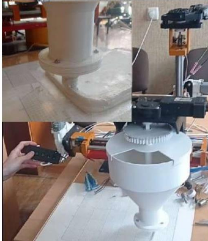
Рисунок 2 – Лабораторний робот-маніпулятор з універсальним екструдером для 3D-друку
