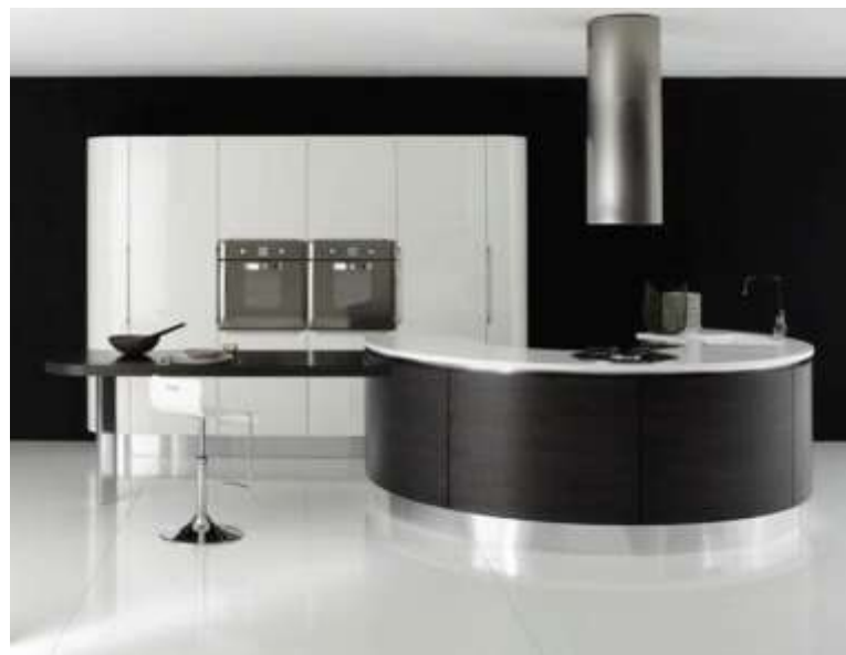
Рис. 8.15. Острівна схема розташування обладнання та меблів у вигляді підкови з приєднаною барною стійкою
