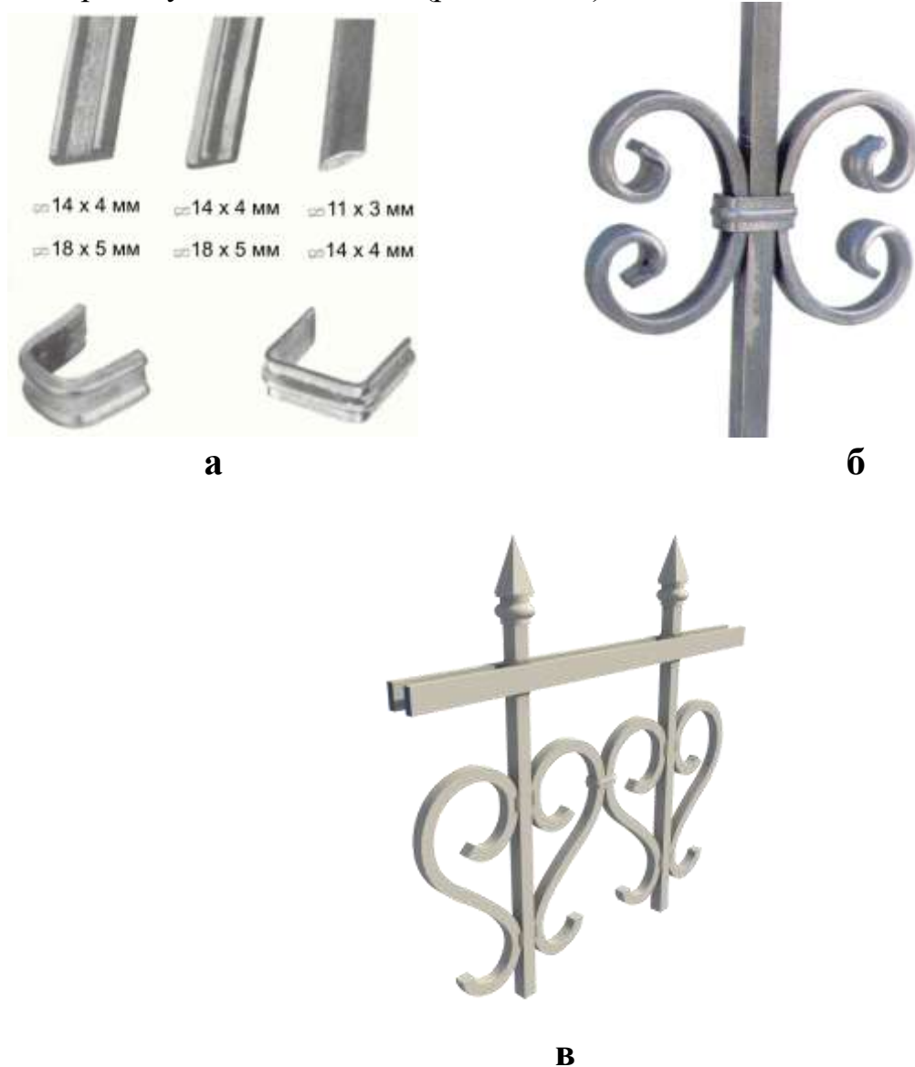
Рис. 2.13. З'єднання елементів огорожі за допомогою хомутиків: а – заготовки для хомутиків; б – приєднання декоративних деталей до стійок за допомогою хомутиків; в – фрагмент огорожі із з'єднанням хомутиком декоративних деталей
