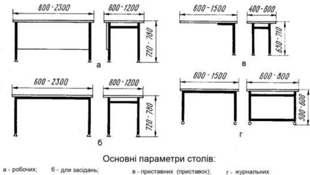
Рис. 9.5. Основні параметри письмових столів (матеріал виготовлення: опори металеві, кришка столу з ДСП вкритого шпоном)
