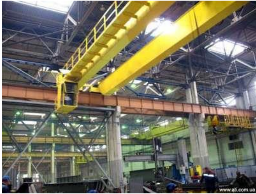
Рис. 13.2. Двобалочний мостовий кран
