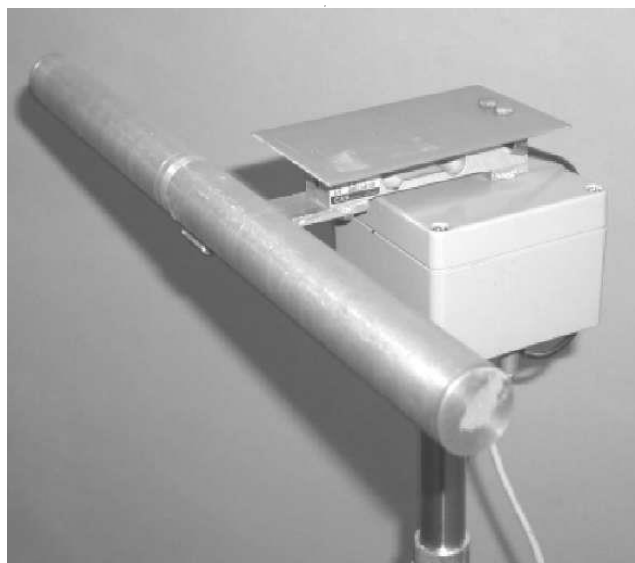
Рис. 15.8. Пристрій для вимірювання ожеледного навантаження АГВМП (модель 2004 р.)
