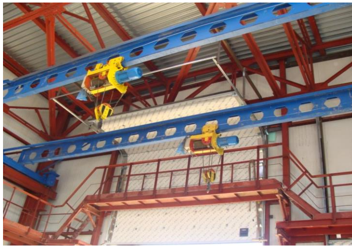
Рис. 13.1. Однобалочні крани (з перфорованою балкою)
