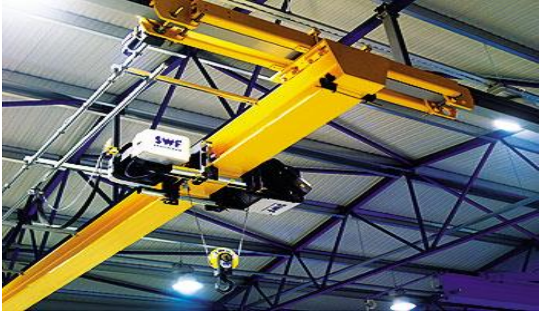
Рис. 13.7. Підвісний кран (кран-балка)
