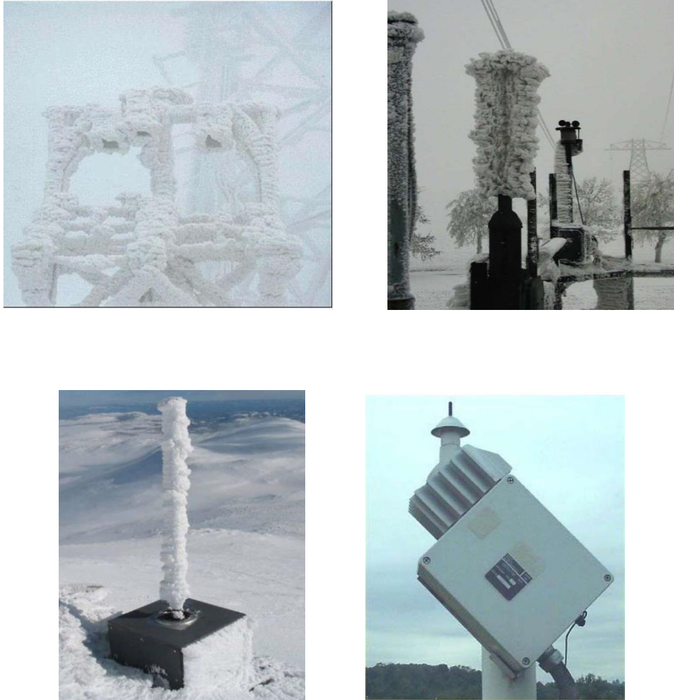
Рис. 15.7. Інструментальні вимірювання ожеледі : а – наростання льоду на установці, що обертається (Великобританія); б – стержень, що вільно обертається, з вимірювальною апаратурою (Чехія); в – вимірювальна апаратура EAG 200(Німеччина); г – сигналізатор обмерзання Rosemount 872/C3 (Канада-США)
