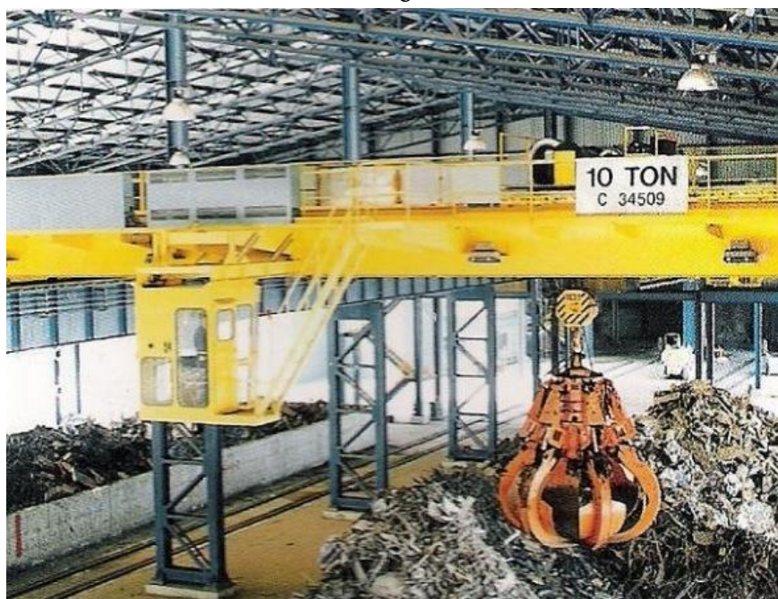
Рис. 13.5. Спеціальні мостові крани: а – магнітний кран; б – грейферний кран
