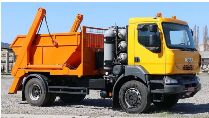
Рис. 4.12. Портальний сміттєвоз на базі шасі КрАЗ-5401Н2 із змінним контейнером ємністю 8м 3 .
