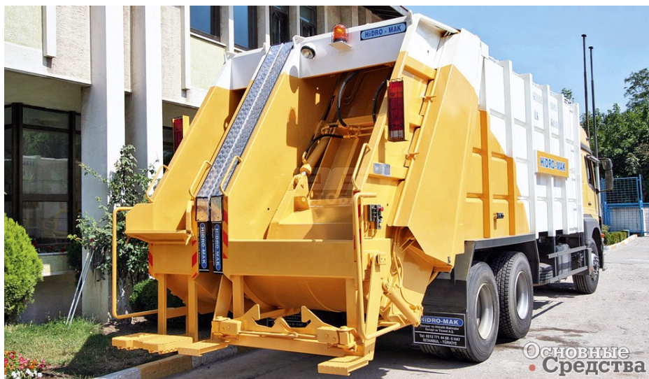
Рис. 4.14. Двосекційний сміттєвоз HIDRO-МАК серії ECOTWiN для роздільного збору відходів
