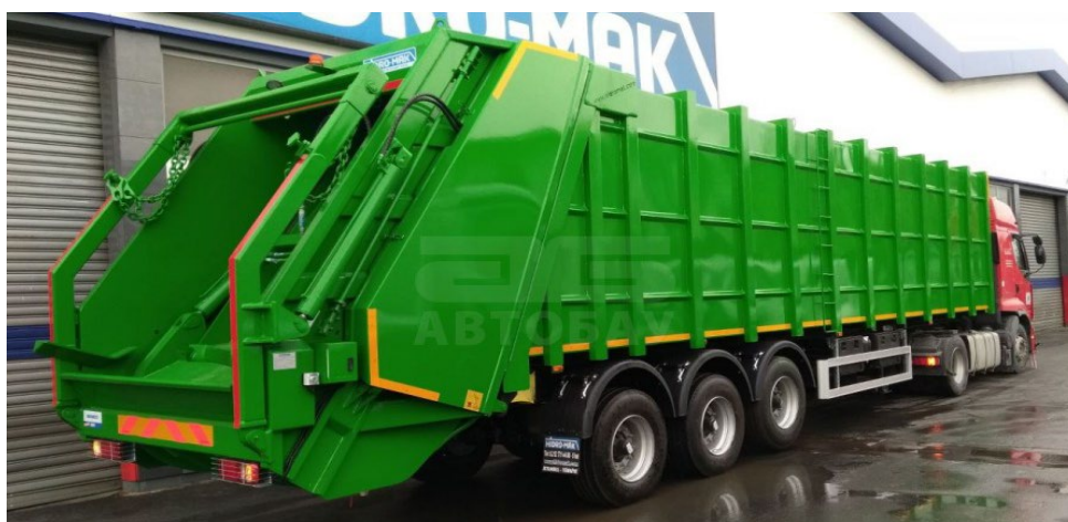
Рис. 4.13. Транспортний сміттєвоз із заднім завантаженням фірми НІДРО-МАК з об'ємом кузова 60м 3 на шасі сідлового тягача RENAULT.
