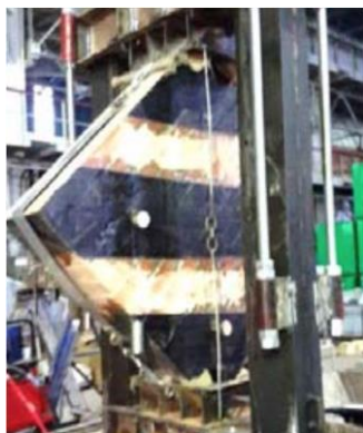
Рис. 4. Кінематична схема руйнування (а) підсиленого в трьох рівнях зразка (б)
