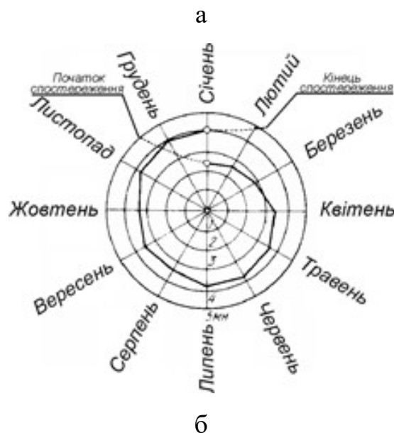
Рисунок 2.5 – Маяк конструкції Білякова (а) та графік розкриття тріщин (б).
