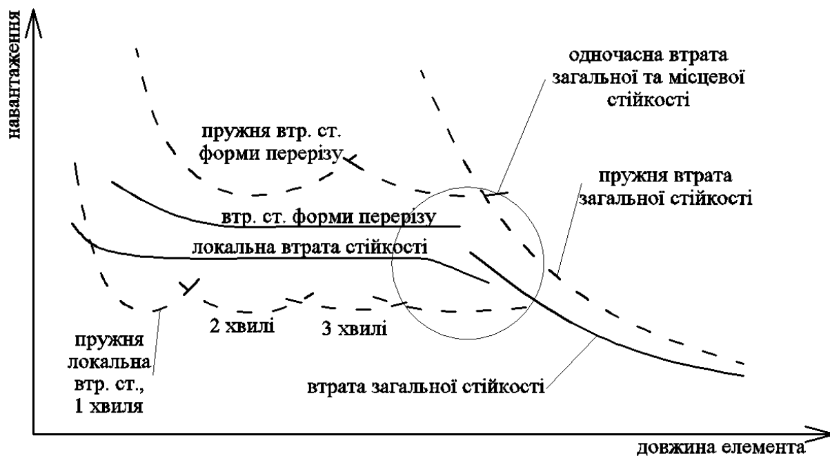
Рисунок 4.2 – Загальна залежність форми втрати стійкості елемента від його довжини та навантаження
